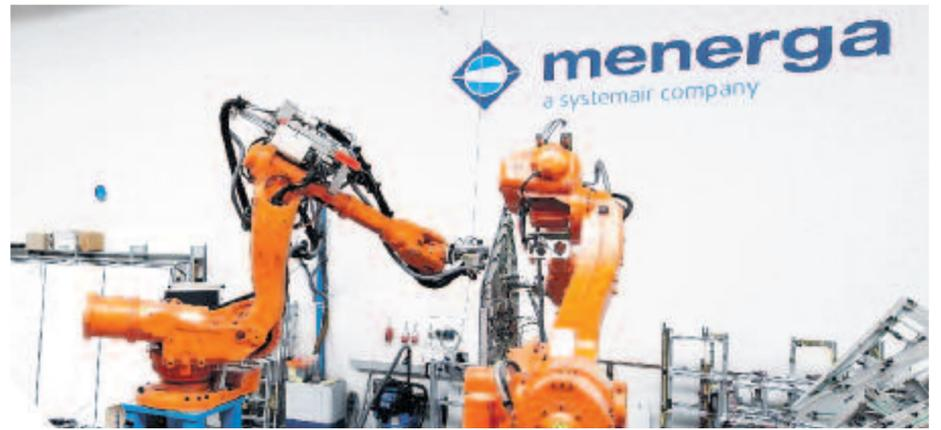
Drei Roboter produzieren bei Menerga Wärmeübertrager aus Polypropylenplatten. (Fotos: Menerga GmbH)
