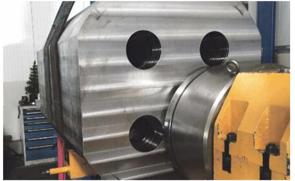
Der Prototyp eines mannshohen Metallbehälters, in dem Brennelemente-Stäbe transportiert werden sollen: Die HBT-Hohlbohrtechnik konnte ihn dank ihrer Erfahrung und Expertise mit vier exzentrischen Bohrungen versehen. (Foto: HBT)
