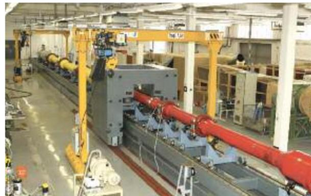
Der Raketenflug im All wird in einem 48 Meter langen Stoßwellenkanal simuliert, den HBT im Labor an der Universität der Bundeswehr in München errichtet hat. Besonderes Know-how war beim Anbringen des Buffers als Druckluftreservoir gefragt. (Foto: Mundt / Universität der Bundeswehr München)
