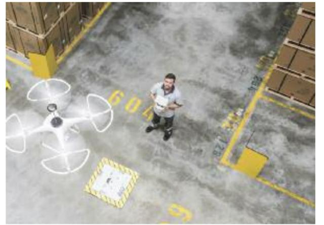
Mithilfe der Drohne wird die Inventur nun schnell und flexibel von einem Mitarbeiter ohne sonstige Hilfsmittel erledigt. Überprüft werden mit dem unbemannten Flugobjekt auch Komponenten der Brandschutzanlage, wöchentlich die Regale oder außen das Hallendach. (Foto: BLG Logistics)
